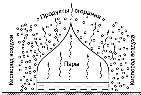
Рис. 1.1. Схема зоны горения паров жидкости — гомогенное горение
