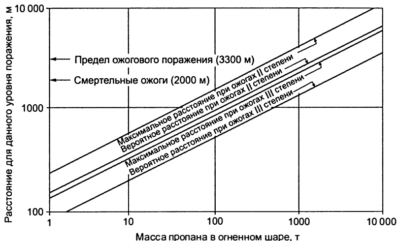
Рис. 2.7. Радиусы теплового поражения от огненного шара, образованного пропаном, в зависимости от его массы
